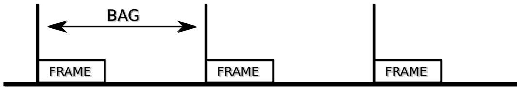
Abbildung 2.6: Die Bandwidth Allocation Gap (GAP) lässt das erneute Senden eines Frames erst nach Ablauf der Zeit wieder zu. (Quelle: Aeronautical Radio Incorporated (2009), S.11)
