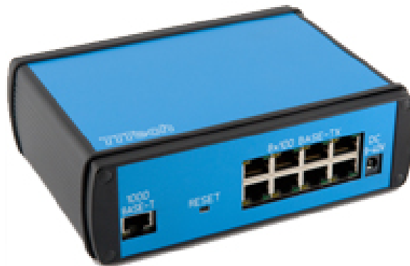
Abbildung 2.1: Switch zur Evaluierung eines TTEthernet-Netzwerks
