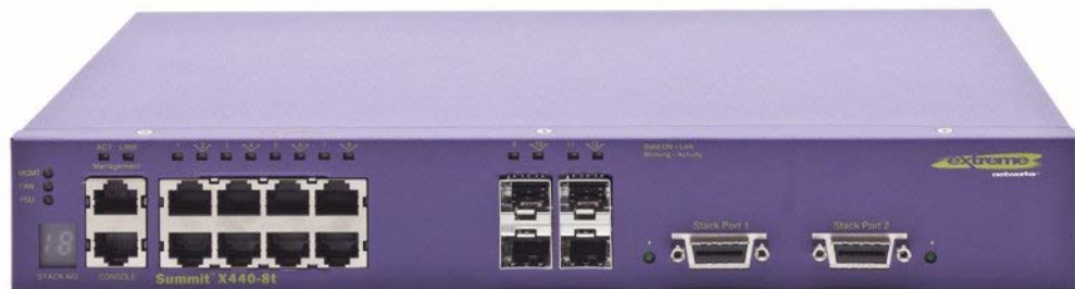
Abbildung 3.2: Extreme Networks Summit X440-8t (Quelle: [2])
