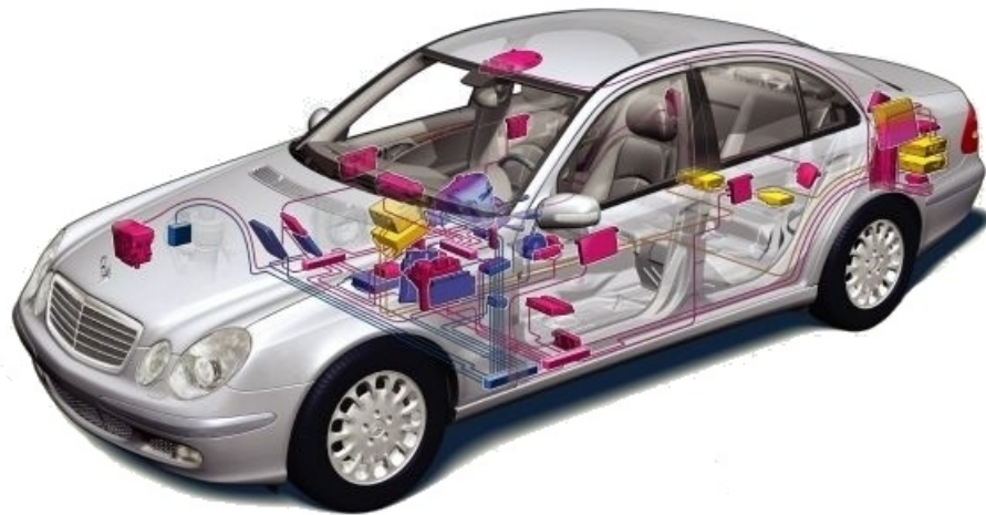
Abbildung 1.1: Vernetzung von elektronischen Endgeräten und deren Bussystem in einem modernem Oberklasse-Fahrzeug. (Quelle: [1])
