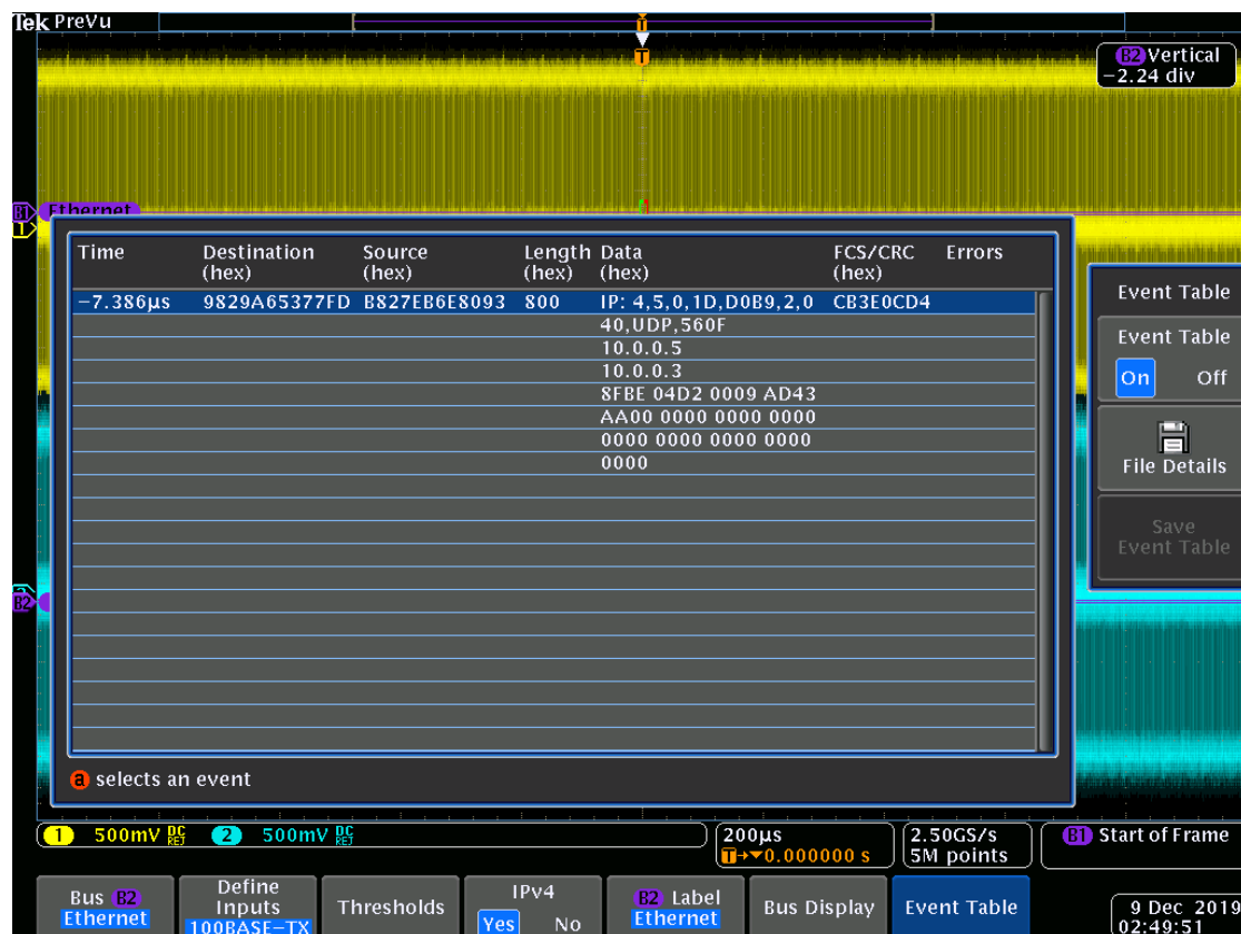
Abbildung 6.8: Latenz des Switches für einen minimalen Ethernet-Frame
